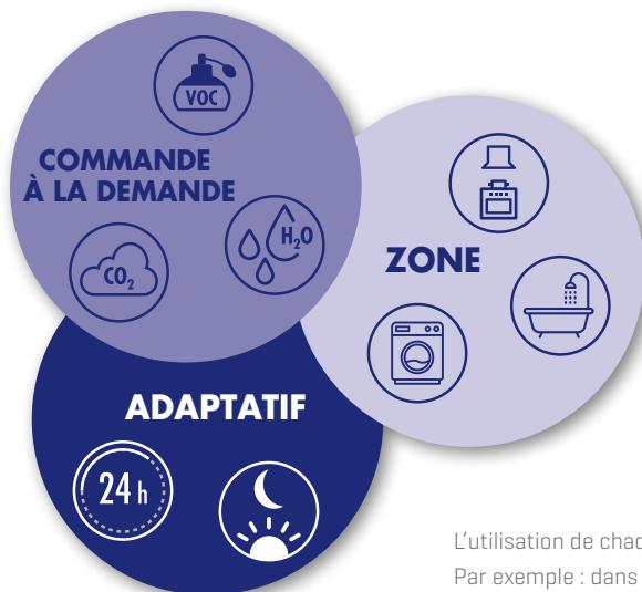
L'utilisation de chaque pièce est différente. Par exemple : dans la salle de bains, le problème principal est l'humidité, tandis que dans les toilettes c'est l'odeur et dans la chambre à coucher le niveau de CO<sub>2</sub>. C'est pourquoi il faut régler le niveau de ventilation séparément pour chaque pièce.
